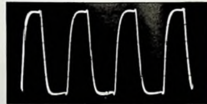
Afb. 21c. Vierkantsgolf weergave bij 12,5 kHz
